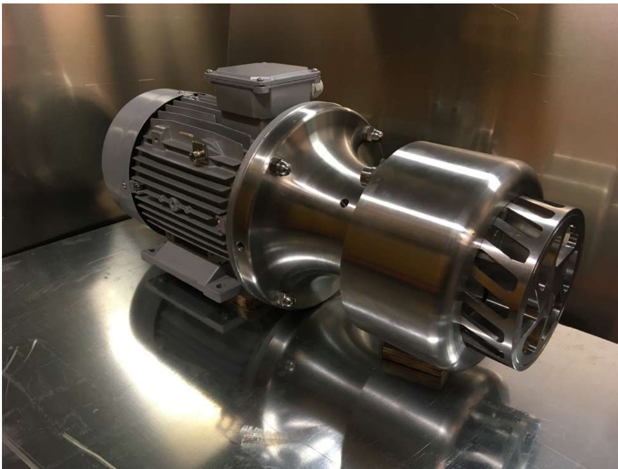
Motore 24 kw - stesse di mensioni di un 7.5 kw
